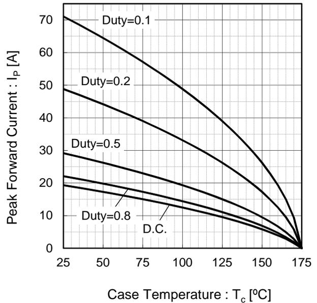
\*4 Based on typ Vf, typ  $R_{th(j-c)}$
