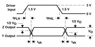
**DRIVER VOLTAGE WAVEFORMS**
