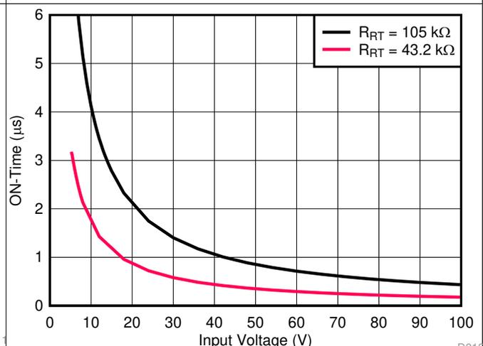
图 10. COT On-Time versus  $V_{IN}$
