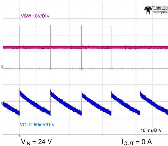
图 25. No-Load Switching
