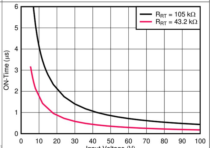
图 10. COT On-Time versus  $V_{IN}$
