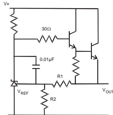
$$V_{OUT} = \left(1 + \frac{R1}{R2}\right) V_{REF}$$
