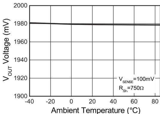
$V_{\text{OUT}}$  v Ambient Temperature
