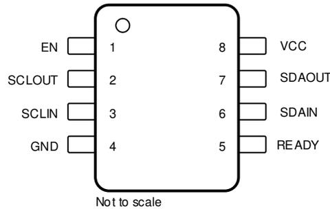
图 5-1. 8-Pin VSSOP, DGK Package (Top View)
