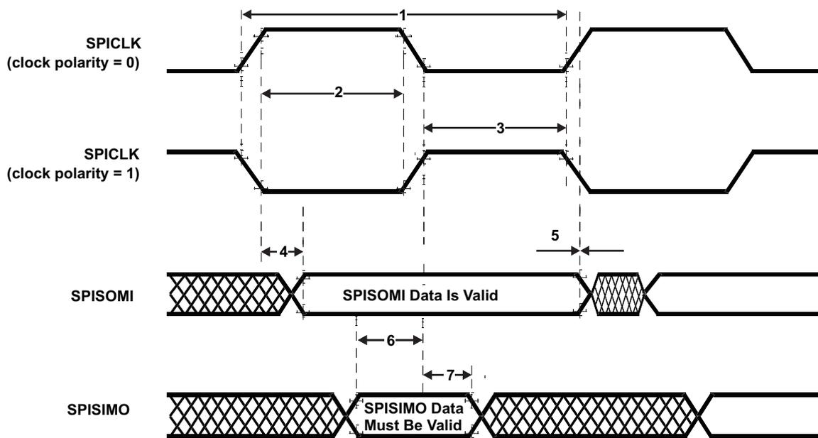
图 6-18. SPI 受控模式外部时序 (时钟相位 = 0)
