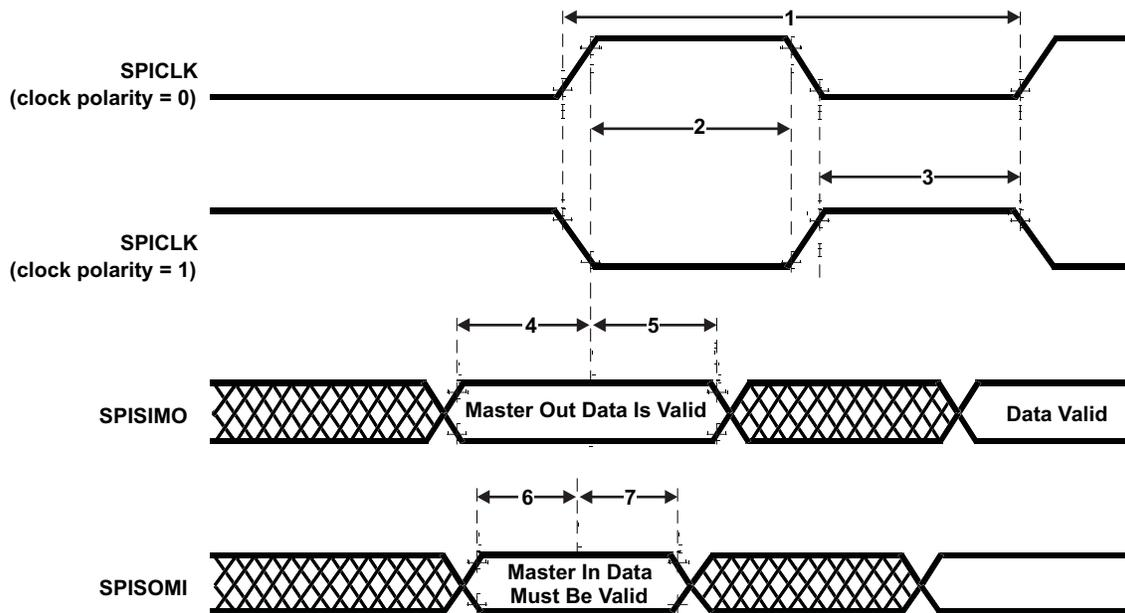
图 6-16. SPI 主控模式外部时序 (时钟相位 = 1)
