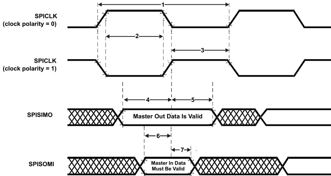
图 6-14. SPI 主控模式外部时序 (时钟相位 = 0)
