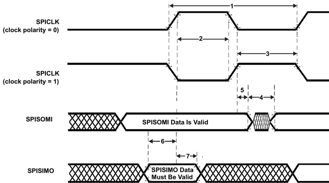
图 6-20. SPI 受控模式外部时序 (时钟相位 = 1)
