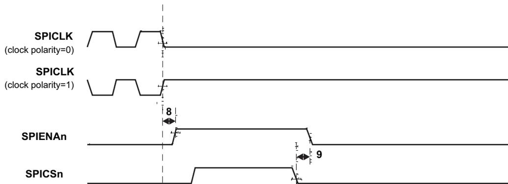
图 6-19. SPI 受控模式使能时序 (时钟相位 = 0)
