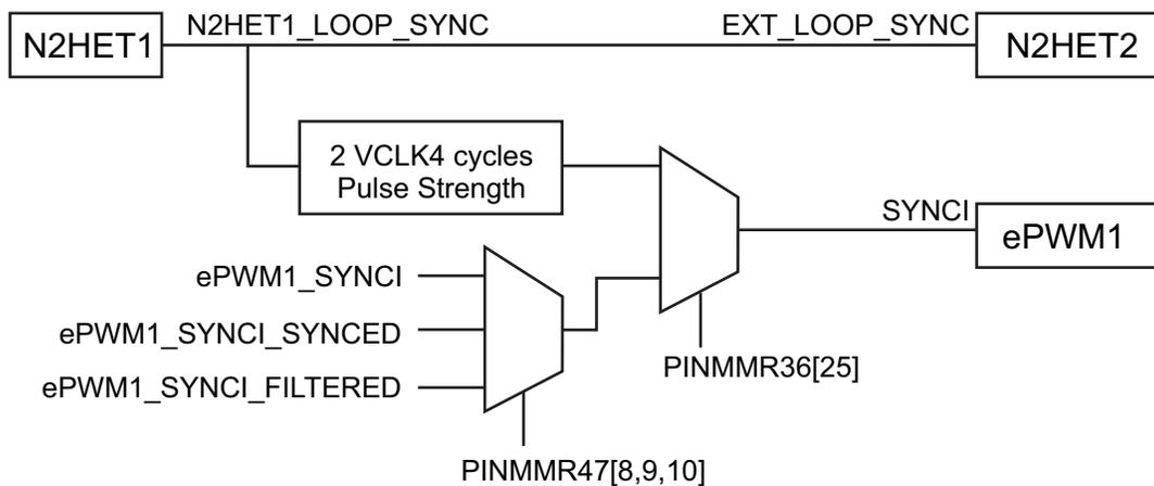
图 6-2. N2HET1, N2HET2 和 ePWMx 间的同步时基
