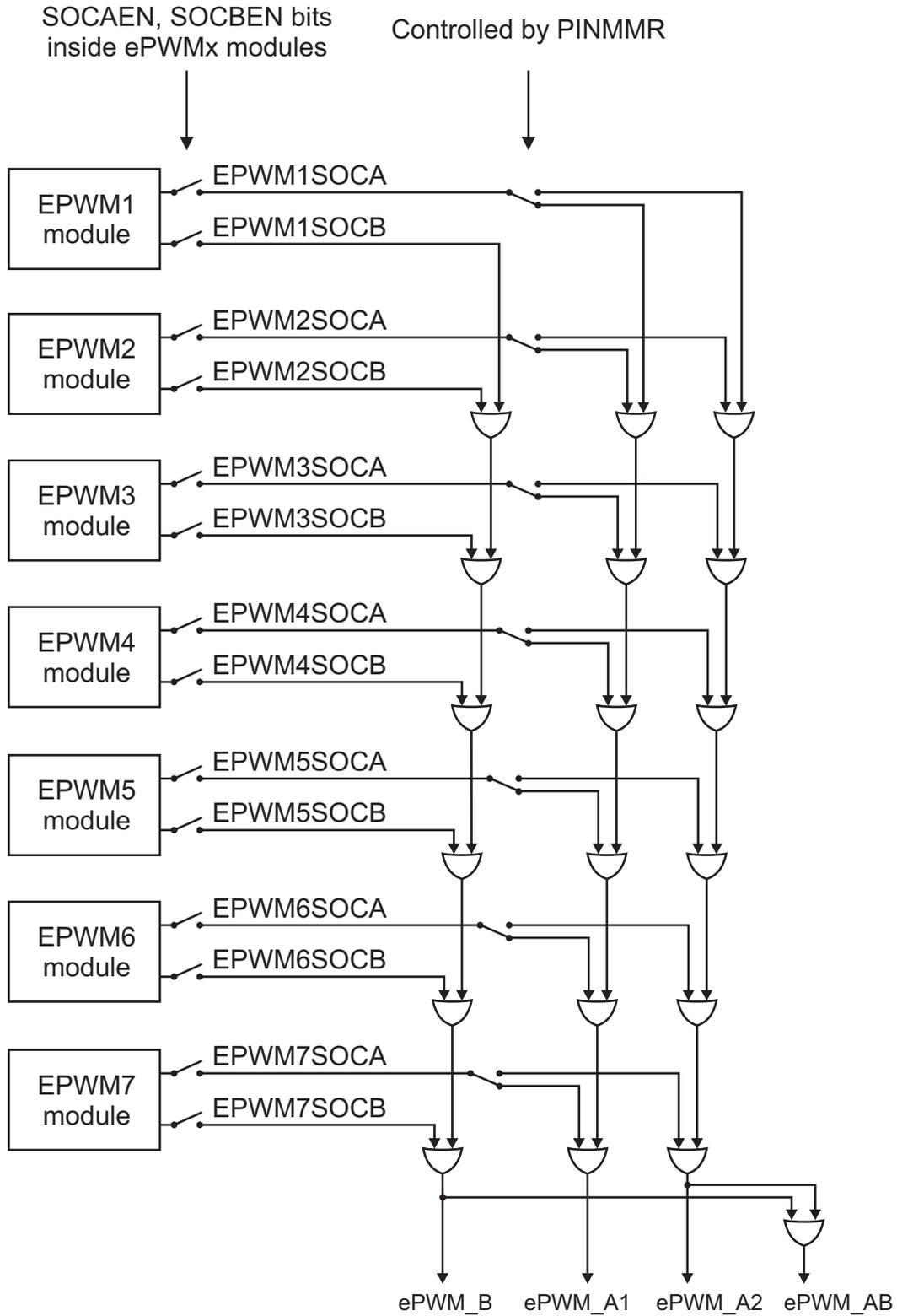
图 6-5. 从 ePWMx 生成 ADC 触发源
