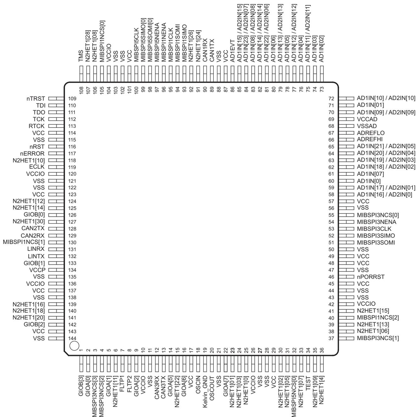
图 3-1. PGE QFP 封装引脚分配 (144 引脚)
