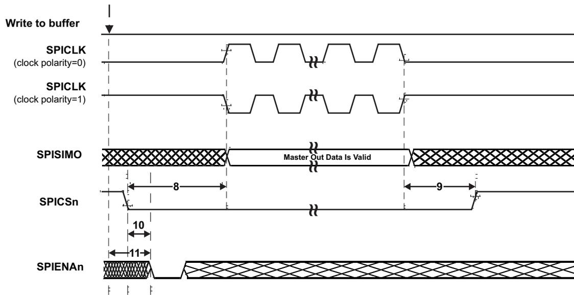
图 6-15. SPI 主控模式片选时序 (时钟相位 = 0)
