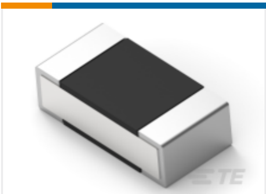
TE 产品编号1-2176306-6 RP 1E 0.1W 1K65 0.1% 25PPM 5K RL
