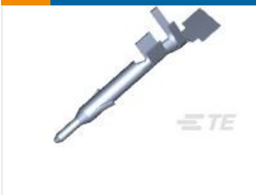
TE 产品编号1-770903-1 MINI UMNL PIN 22-18 AWG AU LF
