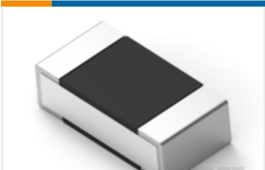
TE 产品编号8-2176309-5 RP 1E 0.1W 75R 0.1% 25PPM 1K RL
