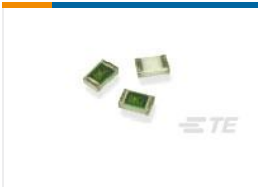
TE 产品编号6-1614353-4 RN 0603 40R2 0.1% 10PPM CUT LE
