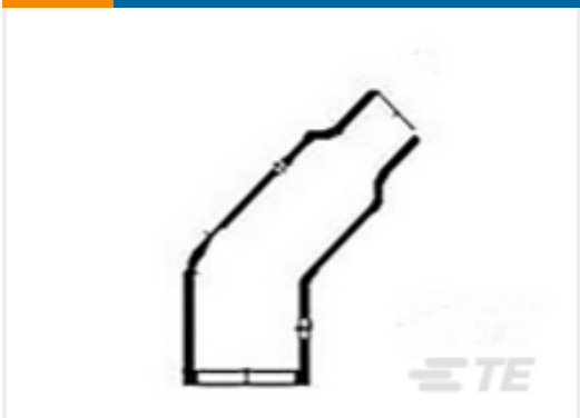
TE 产品编号642427-000 热缩护套：聚合物成型，有嘴
