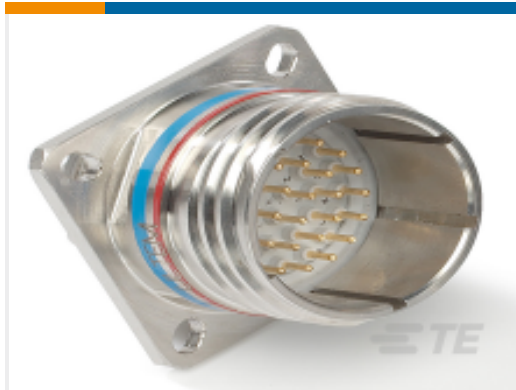
TE 产品编号DTS20F17-06PN D38999：方形凸缘，17-06 插件
