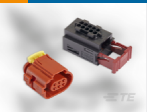
TE 产品编号1-967621-4 定时器，连接器壳体
