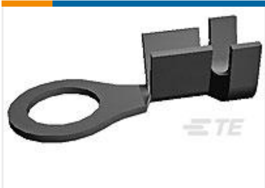
TE 产品编号160701-2 RING TONGUE 18-14 AWG .030 X .394 NPSTL
