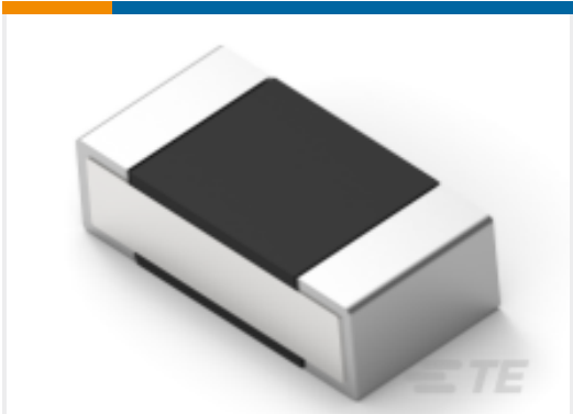
TE 产品编号4-2176309-9 RP 1E 0.1W 31R6 0.1% 25PPM 1K RL
