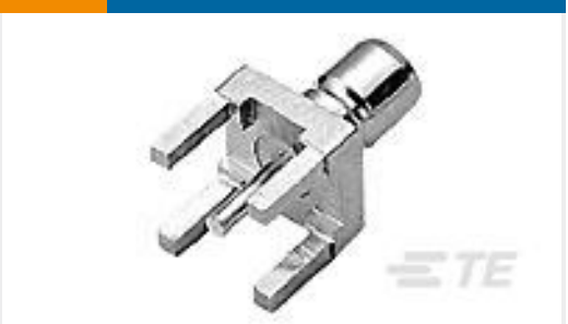
TE 产品编号1-1337482-0 SMB Str PCB Skt 50Ohm Gold Plt
