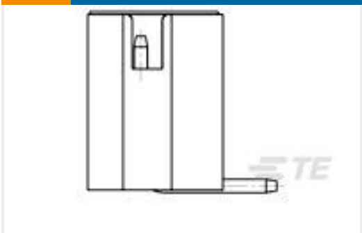
TE 产品编号1775470-7 HPI CONN., 2.0MM, V/T, SMT, 7P, 80U"
