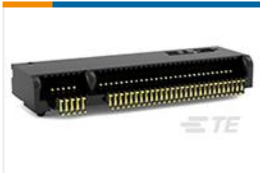
TE 产品编号2199119-9 M.2 0.5PITCH 3.2H KEY A 30U" AU
