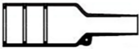
TE 产品编号811216-000 球形热缩护套：有嘴，直形
