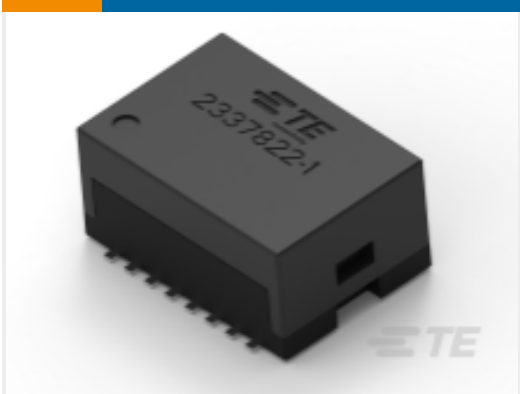
TE 产品编号2337822-1 DISCR.ETH.MAG. 10/100 SINGLE SMT
