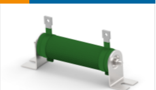
TE 产品编号3-1879454-5 线绕电阻器：矿物，2.5 Kw
