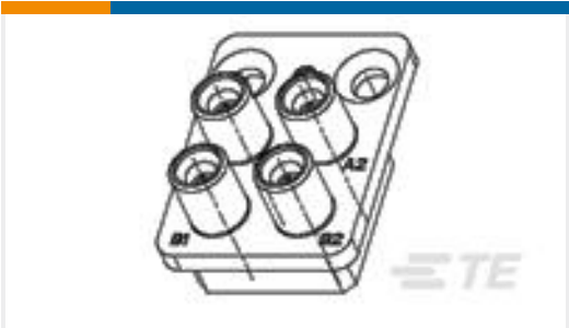
TE 产品编号1996884-1 4 Pos RF Module, Backplane, SMPM
