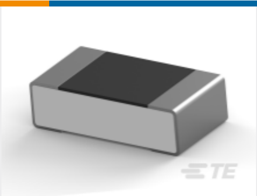
TE 产品编号1-2176370-9 RQ 0603 665R 0.1% 10PPM 5K RL
