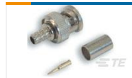
TE 产品编号5-1634502-2 BNC Str Plg Hex 75Ohm Nickel Pltd RG59B/
