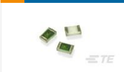
TE 产品编号1-2176092-8 RP 2A 0.25W 1K0 0.1% 25PPM 1K RL
