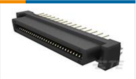
TE 产品编号 1734101-3 Champ050 series,30pos,Au over PdNi
