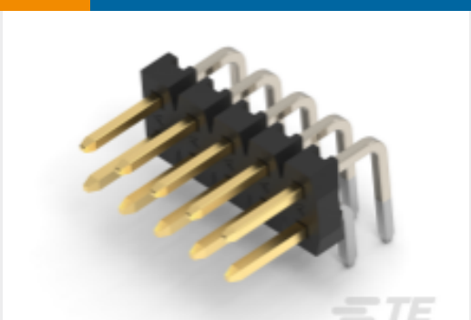
TE 产品编号2842154-5 10P,2MM,BRK HDR,DRRT,2.8,0.1AU,TB W/CAP
