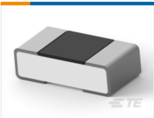
TE 产品编号1-2176363-8 RQ 0402 649R 0.1% 10PPM 5K RL
