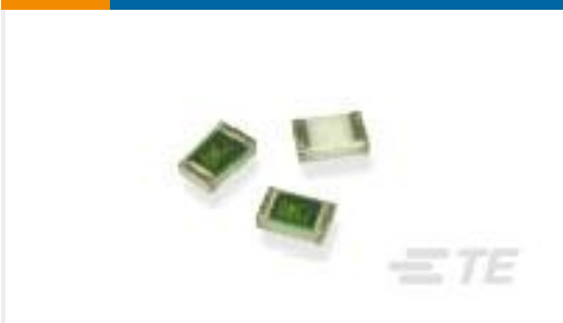
TE 产品编号9-2176089-8 RP 1J 0.166W 124K 0.1% 25PPM 1K RL
