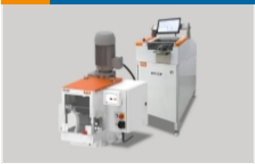
高压线束加工设备(24)
