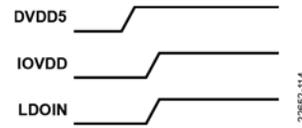
图97. 内部LDO模式下的上电时序
