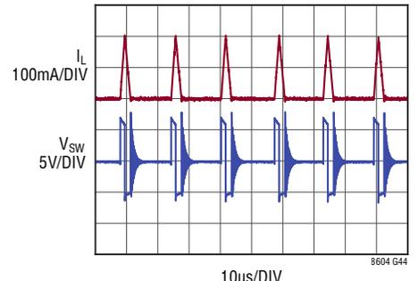
12V<sub>IN</sub> TO 5V<sub>OUT</sub> AT 20mA
