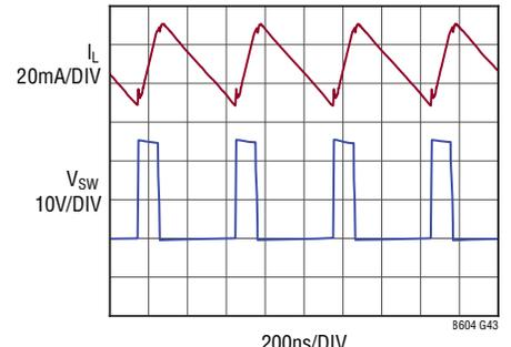
24V<sub>IN</sub> TO 5V<sub>OUT</sub> AT 0mA
