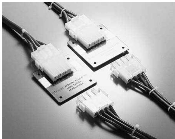
大電流用パワーコネクタで、中継用（2極、9極）と基板用（4極）があります。基本設計は当社ラックアンドパネルコネクタに基づいており、最大定格電流30AでUL498に基づく試験電圧280V、試験電流45A、力率0.75での開閉試験250回を満足しております。
